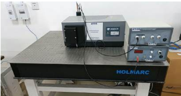
हाई रेज़ल्यूशन यूवी-विज़िबल मॉनोक्रोमेटर (फोकल लेंथ 500 एमएम, आपर्चर रेशियो एफ/6.5, वेवलेंथ कवरेज 190 एनएम-900 एनएम, स्पेक्ट्रल रेज़ल्यूशन 0.05 एनएम विद् 10 एमएम वाइड स्लिट्स)
