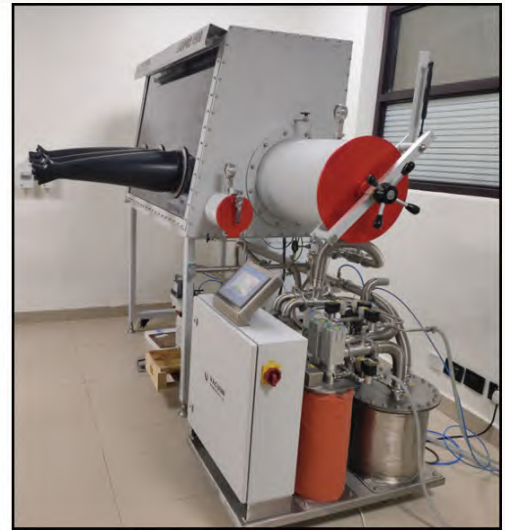
ली-आयन बैटरी के निर्माण के लिए तीन-पोर्ट दस्ताने बॉक्स प्रणाली
