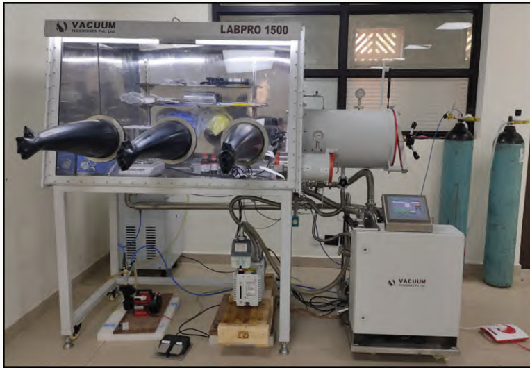
ली-आयन बैटरी के निर्माण के लिए तीन-पोर्ट दस्ताने बॉक्स प्रणाली
